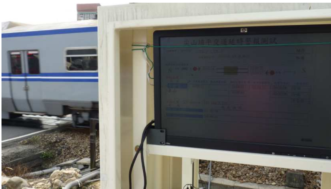
圖5-30 延時警報測試過程
