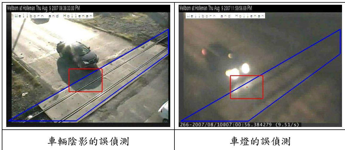
圖2-13 影像辨識誤偵測案例
